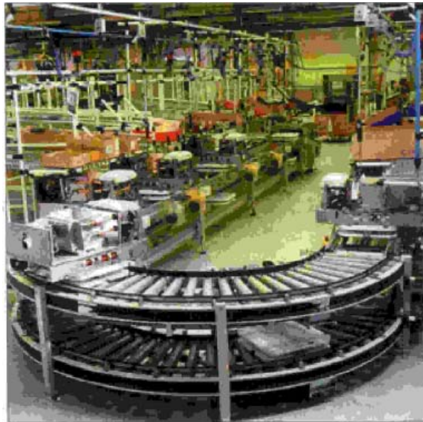
شکل ۳-۹- نمایی از خط اسمبلی U شکل، خط ریل بالایی برای اسمبل کردن بویلرها و خط ریل پایینی برای بازگشت محفظه های خالی
