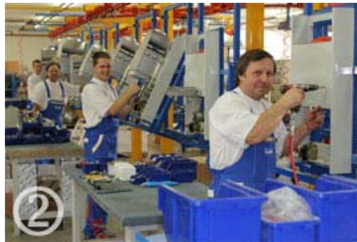
شکل ۳-۱۷ خط تولید بویلر چگالشی
