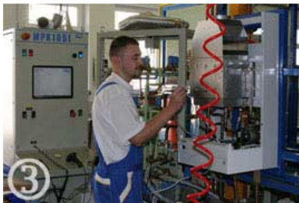
شکل ۳-۱۸ سیستم تست بویلرهای چگالشی
